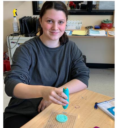
Plástico calentado que se endurece rápidamente, lo que permite a los usuarios dibujar en 3D.
